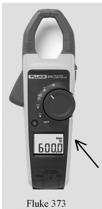
Рисунок 1 - Внешний вид клещей модели Fluke 373, стрелкой показано место нанесения знака утверждения типа.
