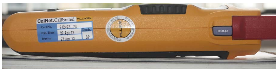
Рисунок 3 - Место пломбирования от несанкционированного доступа
