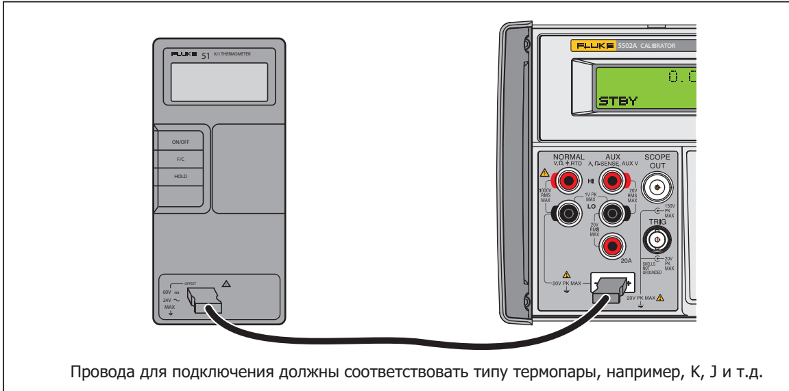
Рисунок 4-10. Подключение испытываемого устройства: Температура (Термопара)
