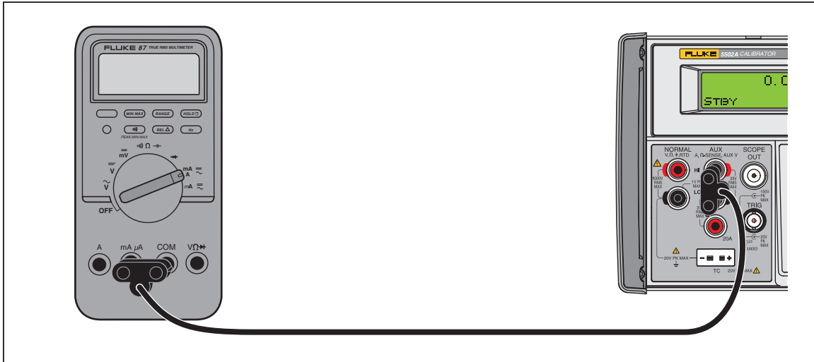
Рисунок 4-8. Подключение испытываемого устройства: Постоянный ток/Переменный ток
