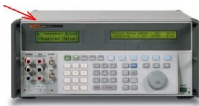
Рисунок 2 – Схема пломбировки от несанкционированного доступа.
