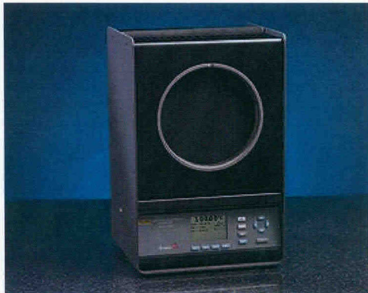
Рисунок 1 - Калибратор температуры инфракрасный Fluke 418
