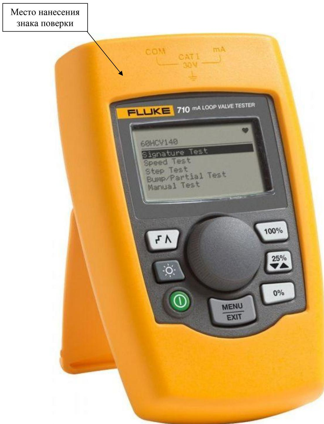
Рисунок 1 – Общий вид тестеров токовой петли Fluke 710
