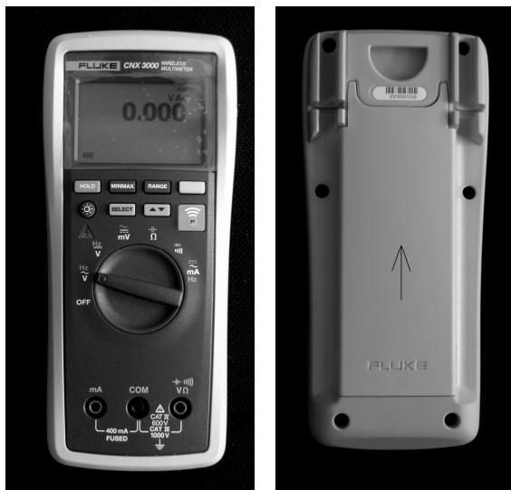
Рисунок 1 - Внешний вид мультиметра с функцией дистанционного сбора и передачи данных Fluke CNX 3000. Стрелкой на нижней поверхности мультиметра стрелкой показано место нанесения знака утверждения типа. На нижней поверхности хорошо видны углубления для крепежных винтов, которые технически позволяют пользователю при необходимости осуществить пломбирование мультиметра.
