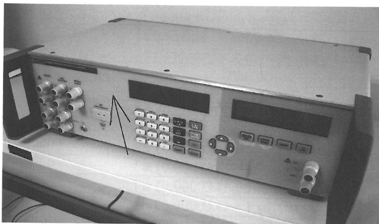
Рисунок 1 - Внешний вид калибратора в разных ракурсах. Стрелкой показано место нанесения знака утверждения типа.
