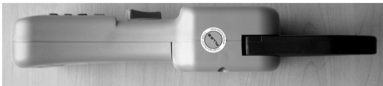
Рисунок 2. Место пломбирования от несанкционированного доступа.
