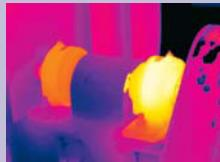
Перегрев крышки подшипника
